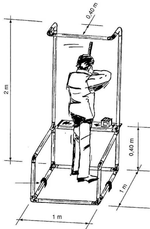
Střelecké stanoviště vyrobené z barevných trubek PVC 50MM průměr, s uzamčenými spoji. Spodní elementy jsou plněny vodou či pískem nebo jsou zakotvené do země.
